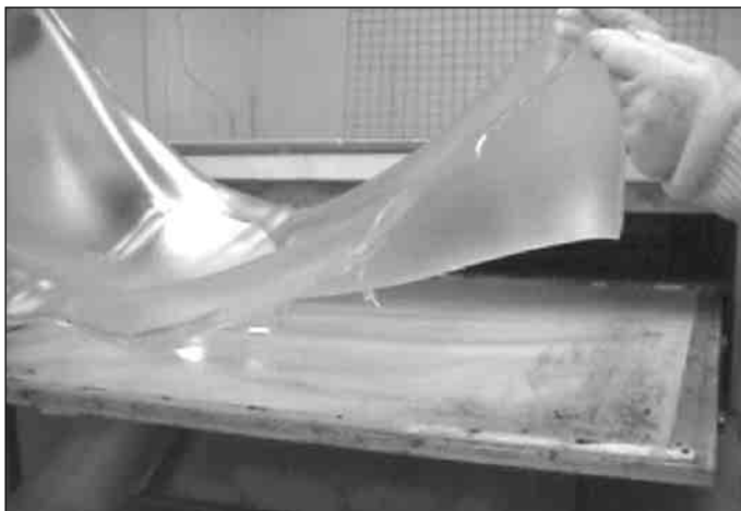
Εικόνα 7. Αποσπασμός του θερμοπλαστικού φύλλου από τον φούρνο. Σε αυτή την φάση παρατηρούμε την μεγάλη πλαστικότητα που παρουσιάζει.
