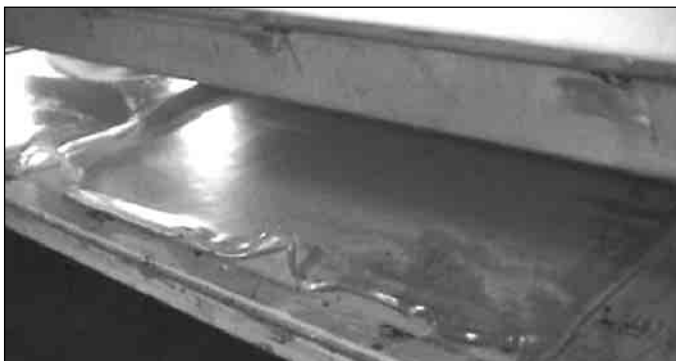
Εικόνα 6. Θερμοπλαστικό φύλλο στην φάση της ναλώδους μετάβασης. Παρατηρείστε την διάφανη εικόνα, σαν ύαλος, που παρουσιάζει το πριν από λίγο λευκό αδιαφανές φύλλο.
