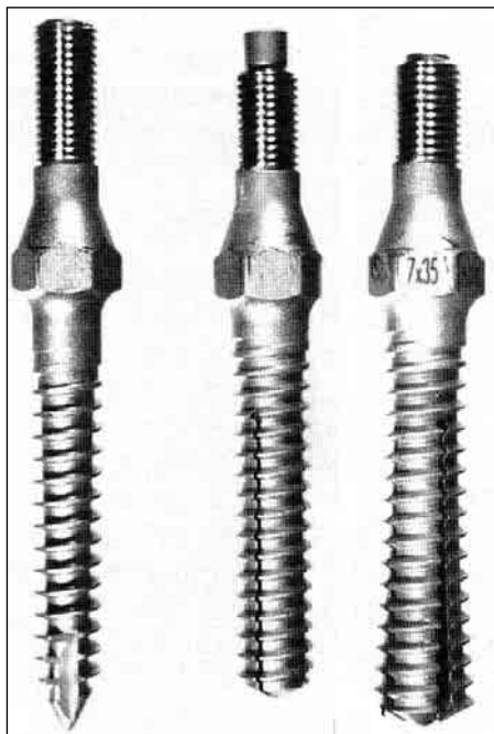
Εικόνα 5. Οι βίδες προς μελέτη. Η διάμετρος του τελικού τμήματος της βίδας διατεινόμενου άκρου αυξάνεται κατά 2 mm μέσω ενός δεύτερου εσωτερικού κοχλίου.
