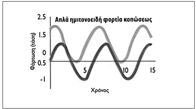
Εικόνα 16. Οι απλούστερες δυνατές φορτίσεις σε κόπωση.
